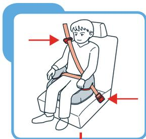
Bringen Sie die Sitzerrhöhung auf dem Autositz an. Stellen Sie sicher, dass die Sitzerrhöhung fest an der Rückenlehne des Fahrzeugs anliegt. Benutzen Sie den 3-Punkt-Gurt des Fahrzeugs, um das Kind anzuschließen und zu sichern. Achten Sie darauf, dass Schulter- und Beckengurt richtig am Körper des Kindes **und der Sitzerrhöhung** positioniert sind (siehe Abbildungen rechts).
